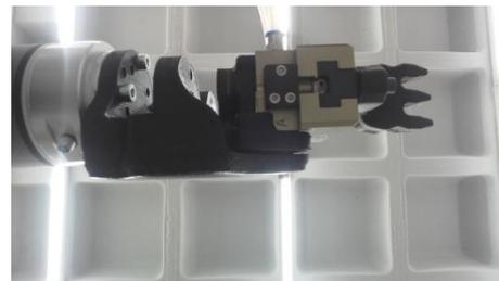
Figura 13: Montaje adaptador + pinza + garra sobre CoBot UR5
