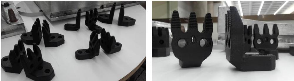
Figura 6: Diversos diseños de garra construidos en ABS por fabricación aditiva (FDM)
