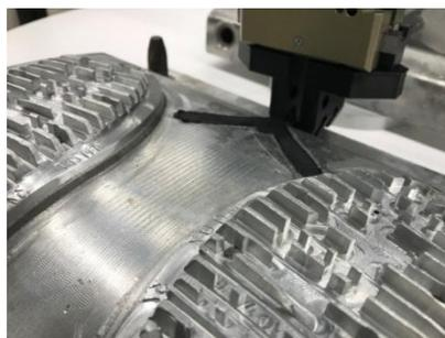
Figura 4: Validación de garra para extracción de mazarota
