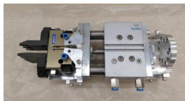
Figura 19: Garras en acero y conjunto mordazas mecanizadas en aluminio
