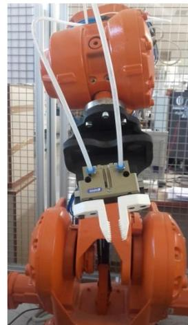
Figura 12: Montaje adaptador + pinza + garra sobre robot ABB
